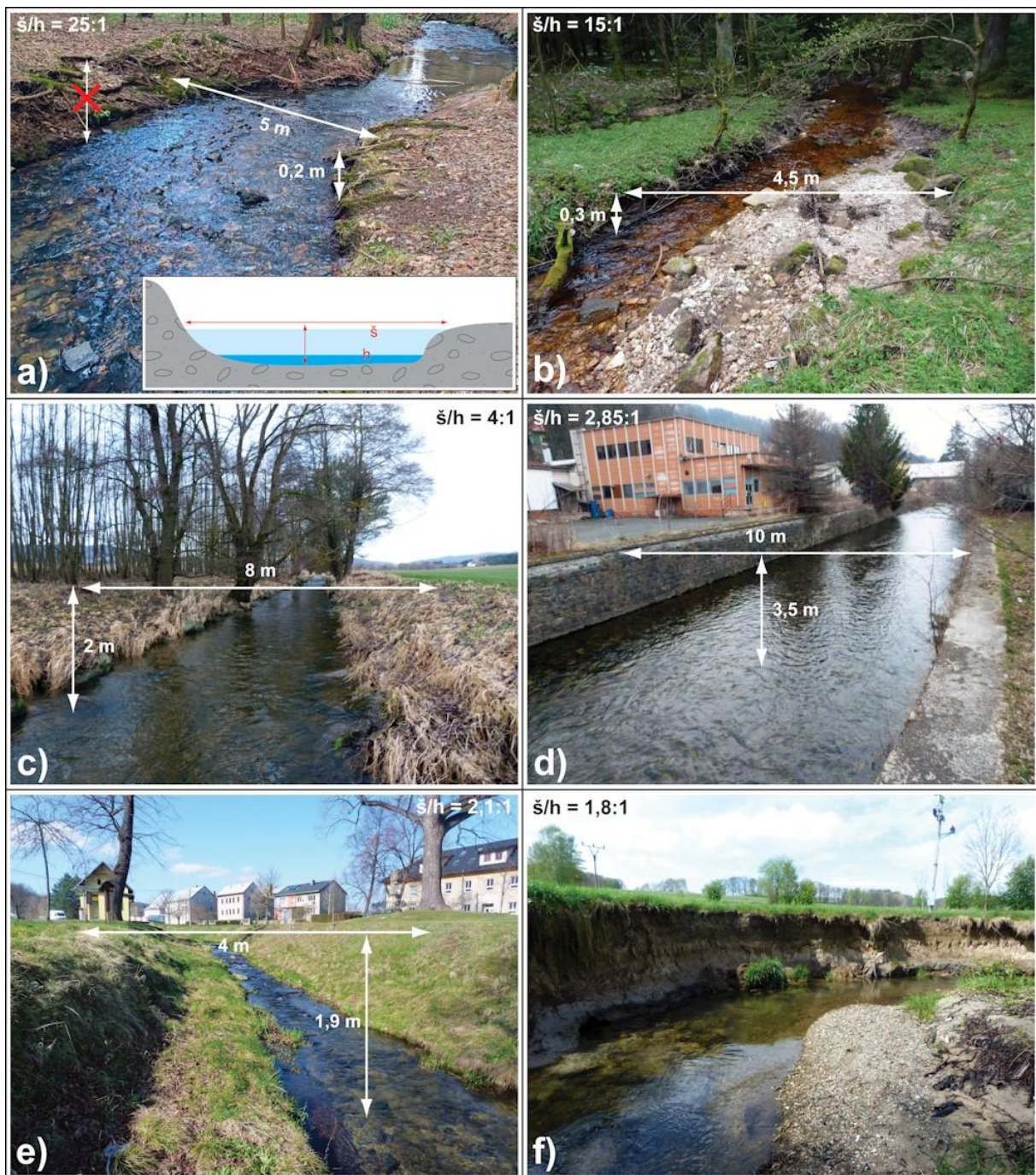
Obr. 37: Konkrétní příklady vodních toků s rozdílným indexem zahloubení, (a) přirozené koryto s nízkým zahloubením (kategorie 1), hloubka koryta se měří dle nižšího z břehů; (b) přirozené koryto s nízkým zahloubením (kategorie 1), šířka i hloubka koryta se měří od břehové hrany; (c) středně zahloubené, regulované koryto (kategorie 2); (d, e) upravené koryto s vysokým zahloubením (kategorie 3); (f) koryto bez úprav s probíhající akcelorovanou hloubkovou erozí a vysokým zahloubením (kategorie 3)
