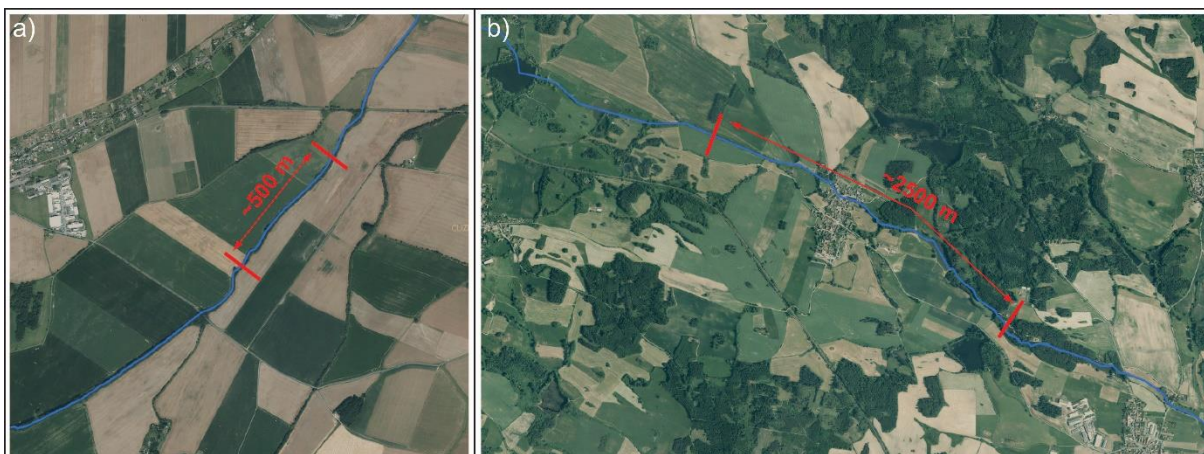
Obr. 7: Vymezení hodnoceného úseku v případě dvou různých toků s podobnou šířkou koryta (do 8 m), (a) napřímený vodní tok v kulturní krajině se stejnorodými morfologickými parametry koryta – možnost vymežit kratší hodnocený úsek; (b) vodní tok protékající mozaikovitou krajinou – nutnost vymežit delší hodnocený úsek
