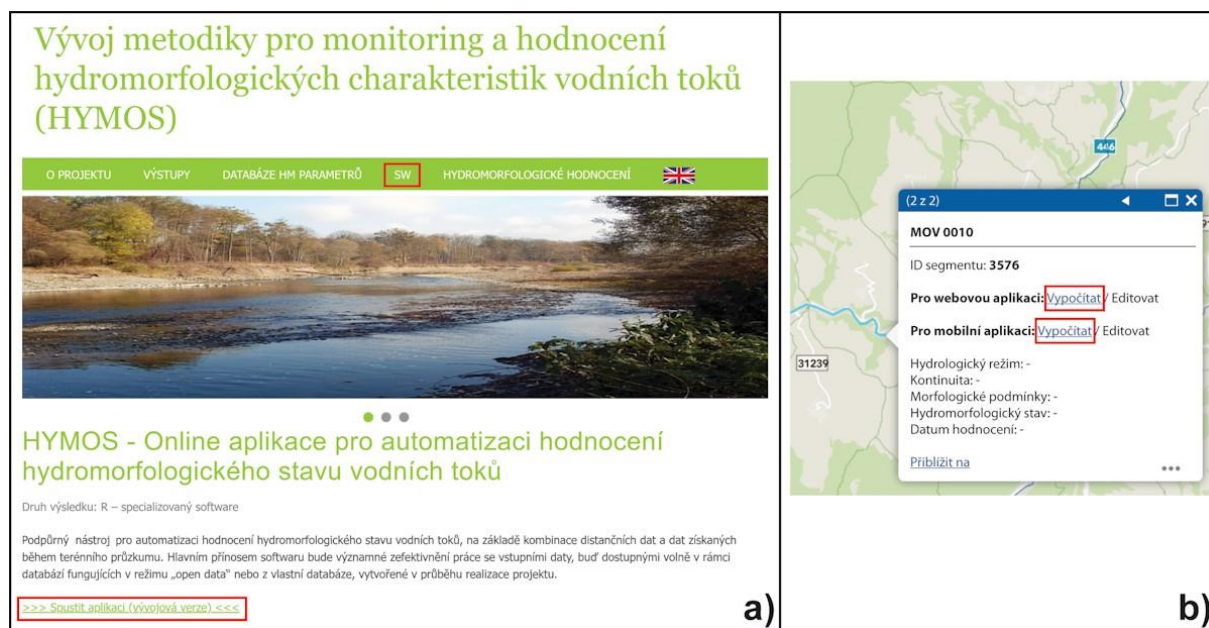
Obr. 49: Cesta k online formuláři pro hodnocení vodních útvarů, (a) odkaz na oficiálních webových stránkách; (b) výběr úseku vodního útvaru a odkazy na webovou/mobilní aplikaci.
