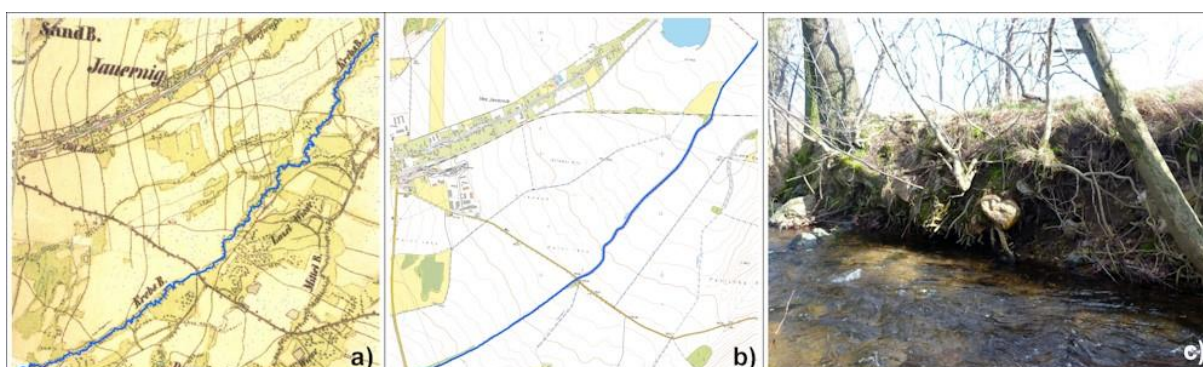
Obr. 35: Na mapách 2. vojenského mapování je vidět Račí potok se zákrutovým půdorysným tvarem s vysokou křivolakostí, místy přecházejícího do meandrování (a), potok byl uměle napříměn (b), břehy nejsou v současnosti stabilizované a dochází k renaturačním procesům (c), vodní tok je hodnocen kategorií 3 a jsou odečteny 3 body za přítomnost renaturačních procesů
